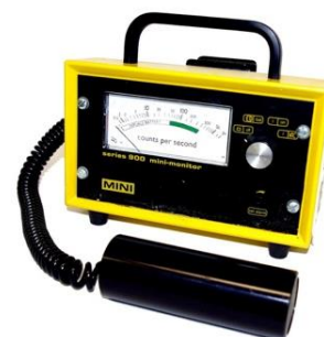
Εικόνα 4-6: Αναπαράσταση της αρχής λειτουργίας του ανιχνευτή Geiger-Müller (αριστερά) και μια πραγματική φωτογραφία του ανιχνευτή (δεξιά). Ιονίζουσα ακτινοβολία προσπίπτει στον ανιχνευτή, ιονίζει το αέριο και παράγει ένα ισχυρό σήμα στην έξοδο. Χρησιμοποιείται για την μέτρηση του αριθμού των σωματιδίων της προσπίπτουσας ακτινοβολίας. (Πηγές (13), (14))
